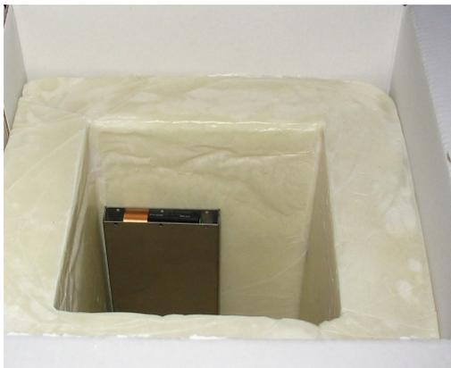
Modèle Froid : un isolant moulé est intégré dans un boîtier inox ou autre et intègre des blocs de matériaux à changements de phase liquide / solide.
