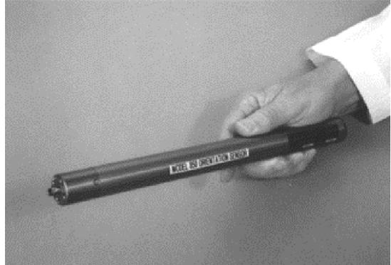
Pour garder une haute précision avec la gamme de température du système, les capteurs sont compensés en température. Ceci permet une précision de +/- 0,1 ° pour l'inclinaison et le roulis et +/- 0,3° pour l'azimut sur toute la gamme de température du système.
