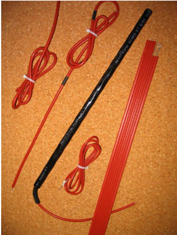
Sur l'image ci-contre, différents éléments géo-fibres de GMG : des gaines comprenant 3 voire 6 fibres ou plus dans une enveloppe flexible ( le capteur en haut à gauche et celui en bas au centre ), un capteur FBG ( 2 en partant du haut à gauche ), un capteur en nappe ( à droite ) et un capteur ' armé ' gainé de noir.
