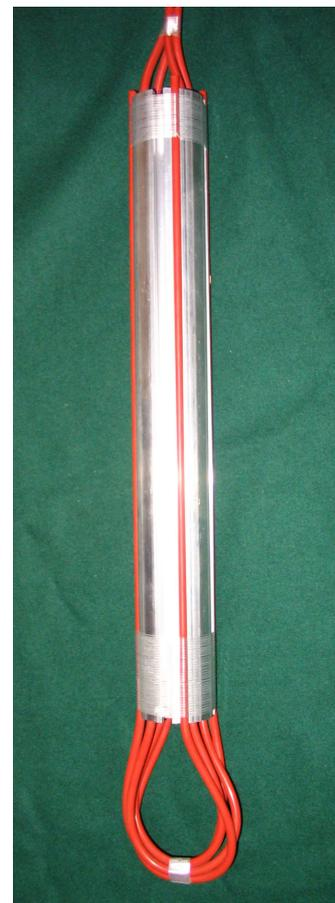
Les deux images montrent un capteur construit. Un tube est instrumenté avec 4 zones capteurs à géo-fibres. Les zones sont à 90 degrés angulaires les unes des autres. Une paire de capteurs à 180 degrés angulaires mesure tractions et compressions suivant une direction. En admettant qu'il n'existe qu'une sollicitation, les deux autres zones capteurs ne seront pas sollicitées.
