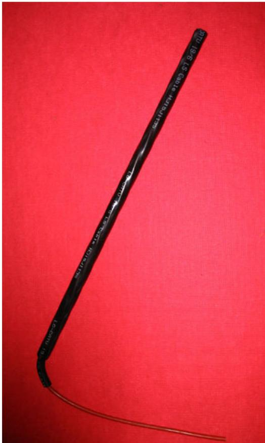
La géo-fibre, dont on voit la partie flexible en partie basse, est enserrée dans une structure métallique multibrin offrant une certaine souplesse mais conservant une rigidité mécanique interdisant les mouvements parasites.
